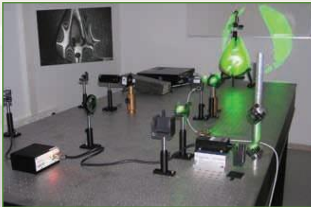
Εργαστήριο Ακουστικής και Οπτικής Τεχνολογίας. Διακρίνεται η διάταξη πιστοποίησης ακουστικής ποιότητας παραδοσιακών μουσικών οργάνων με ολογραφία laser. Στο ένθετο διακρίνεται μέτρηση κανονικού τρόπου δόνησης της κρητικής λύρας.
