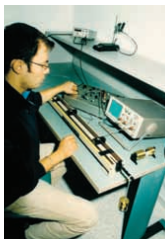
Εργαστήριο Φυσικής Κοματικής όπου διακρίνονται εκπαιδευτικές διατάξεις μελέτης κυμάτων σε χορδή
