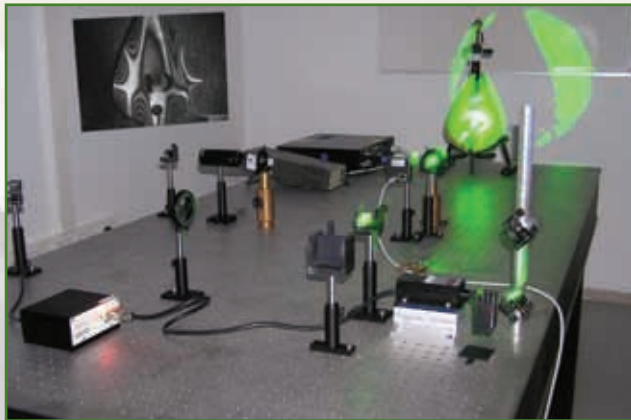
Εργαστήριο Ακουστικής και Οπτικής Τεχνολογίας. Διακρίνεται η διάταξη πιστοποίησης ακουστικής ποιότητας παραδοσιακών μουσικών οργάνων με ολογραφία laser. Στο ένθετο διακρίνεται μέτρηση κανονικού τρόπου δόνησης της κριτικής λύρας.
