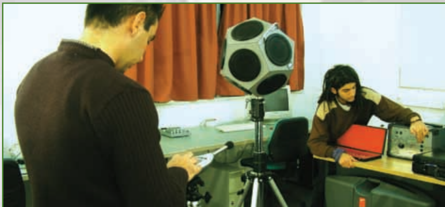
Εργαστήριο Εφαρμοσμένης Ακουστικής όπου διακρίνεται το δωδεκαεδρικό ηχείο για τη μέτρηση του χρόνου αντήχησης εσωτερικών χώρων.
